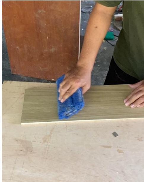
**Gambar 2.** Pelapisan Menggunakan Metode Manual
