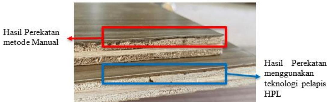
**Gambar 9.** Hasil Pelapisan Menggunakan Manual Dan Mesin Pelapis HPL
