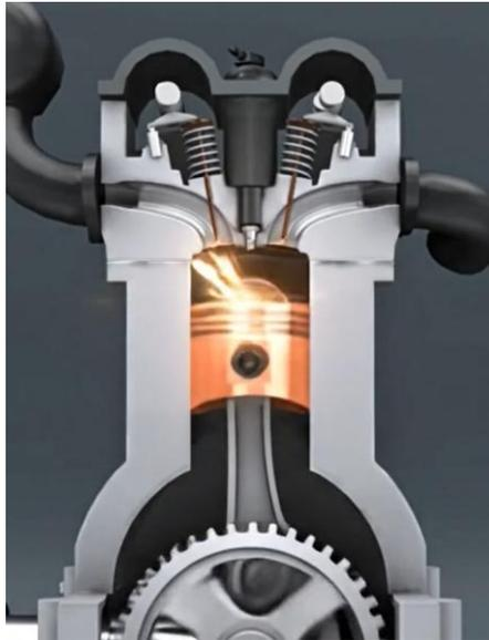
**Gambar 1.** Proses terjadinya pembakaran pada ruang mesin 4 tak
