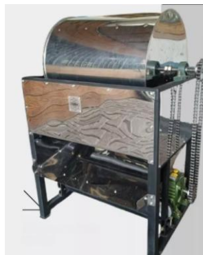
Gambar 2. Hasil Akhir Rotary Dryer yang Siap Digunakan
