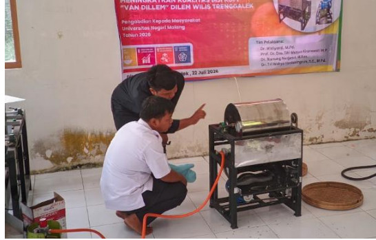
Gambar 3. Uji Coba Penggunaan Rotary Dryer Menggunakan Biji Kopi “Van Dille”
