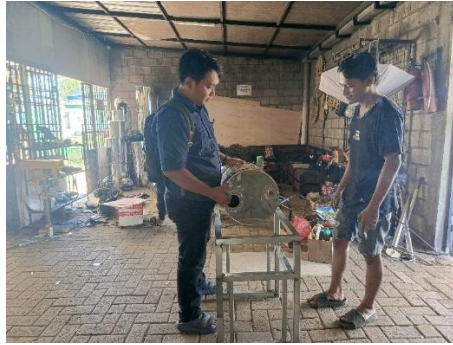
Gambar 1. Proses Perakitan Rotary Dryer pada Tahap Pemasangan Tabung Pengering
