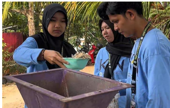
Gambar 4. Proses pencetakan pakan menggunakan mesin pencetak pelet
